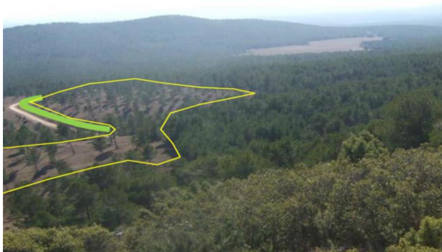
IMAGEN 9. ÁREA CORTAFUEGOS APOYADA EN VIAL. EN AMARILLO LA BANDA AUXILIAR (BA) DEL ÁREA CORTAFUEGOS, LA BANDA DE DECAPADO (D), LA CONSTITUYE EL PROPIO VIAL Y EN VERDE LA BANDA DE DESBROCE (DS)
