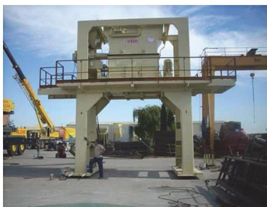
**ADVERTENCIA:** Hasta Que los 4 bulones no estén introducidos, está terminantemente prohibido permanecer bajo la UPM o en las proximidades, de la carga suspendida, se debe establecer un perímetro de seguridad de 3 m.
